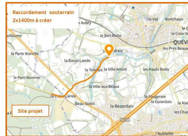
Figure 41 : Tracé prévisionnel de raccordement vers les postes sources de Dinan et de Taden
